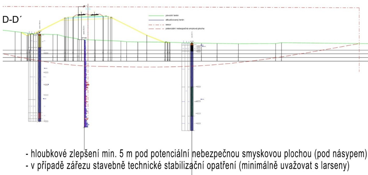
Obrázek 23 – Příčný řez D-D' v km 111,820 s vykreslenou potenciálně nebezpečnou smykovou plochou. Autor: GEOtest a.s.
